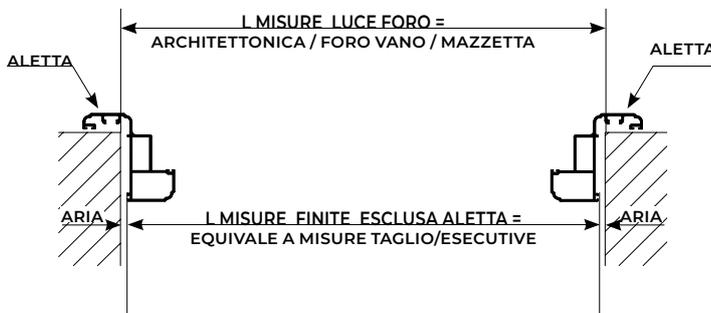
SCHEMA RILIEVI MISURE CON TELAIO
