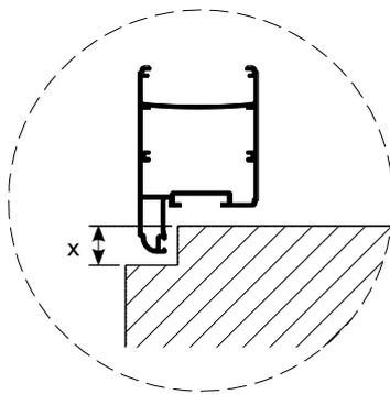
SCHEMI DI RILIEVO MISURE "SU TELAIO"
