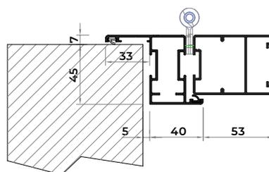
La persiana in alluminio modello ERA a lamelle orientabili a goccia da mm 72, grazie al particolare sistema di aggancio delle stesse garantisce un buon oscuramento ed una buona tenuta alle intemperie e all'infiltrazione di polvere. I meccanismi che comandano l'apertura e la chiusura del sistema sono particolarmente affidabili e silenziosi e disponibili a richiesta in vari colori (consultare l'azienda per disponibilità e maggiorazioni di prezzo).
