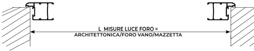
SCHEMA RILIEVI MISURE CON CARDINI A MURO
